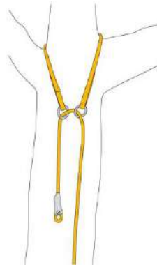
Fig. 8 - Ancoraggio passante per corda raddoppiata
